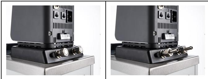
1. Demontieren Sie die Überwurfmutter an den Pumpenanschlüssen.
