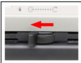
8. Stellen Sie den Hebel für die Einstellung der Strömungsrichtung auf externe Umwälzung.
